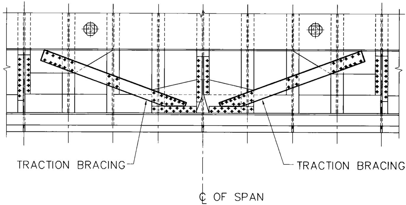
**PLAN VIEW AT CENTER SPAN**
